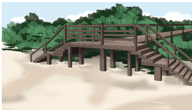
Figura 19. Pasarela en un proyecto de restauración en Telchac-Chixchulub. Se instaló una pasarela en forma de "V" en el frente de playa de los condominios Royal Beach 1, con una elevación aproximada de 50 cm. También se cercó el área revegetada con puntales de madera unidos por cuerda. Fotos: Gabriela Mendoza.
