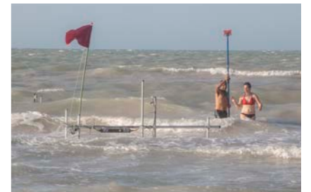
Colocación de medidores de corriente.
